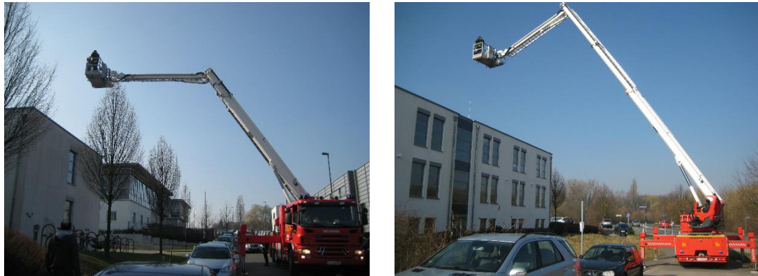
Bild 5 Anleiterprobe in Höhe des 2. Obergeschosses mit der zuständigen Feuerwehr
