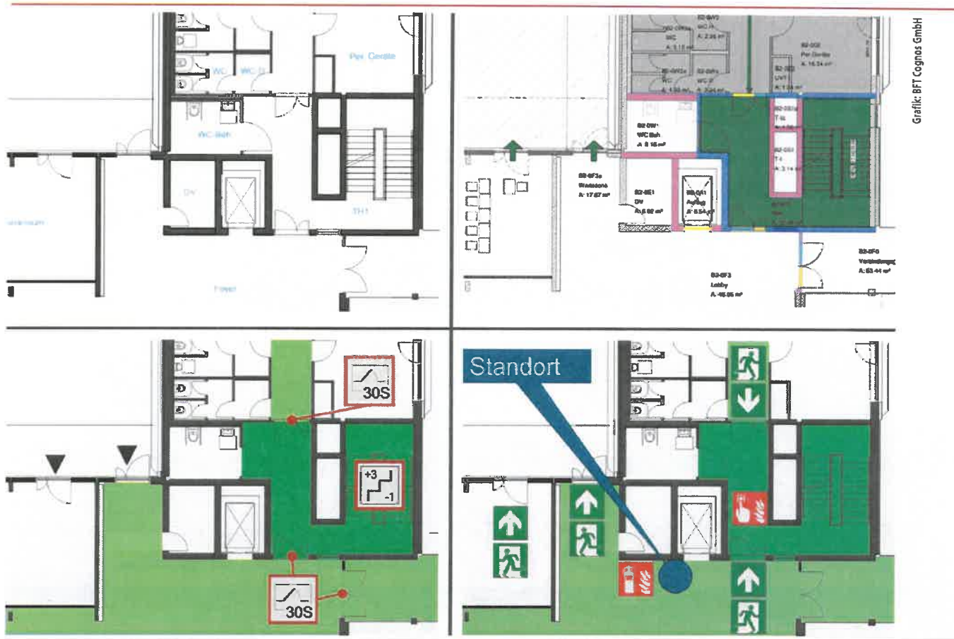
Abb. 1a–d: Visuelle Darstellung der Brandschutzplanung und Brandschutz-, Flucht- und Rettungs- und Feuerwehrpläne
